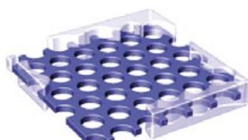
**Selbstorganisation von Stab-Knäuel-Molekülen** mit einer Esterverknüpfung ergab eine supramolekulare 3D-Wabenstruktur mit hexagonaler Symmetrie. Die Hydrolyse der Estergruppe und das Entfernen der Knäuel-Segmente (hellblau) aus der perforierten lamellaren Struktur führten zu kristallinen Schichten (dunkelblau) mit geordneten Nanoporen, die in ihrem hydrophoben Inneren unpolare Moleküle einlagern können.
